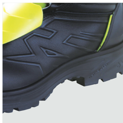
インジェクション製法 アッパーとソールの接合部にPUを注入し接着と成型を同時に行う特殊なインジェクション製法により剥離しにくく高いクッション性を実現
