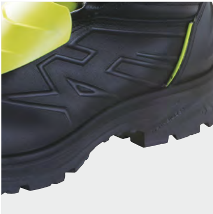
インJECTION製法 アッパーとソールの接合部にPUを注入し接着と成型を同時に行う特殊なインJECTION製法により剥離しにくく高いクッション性を実現
